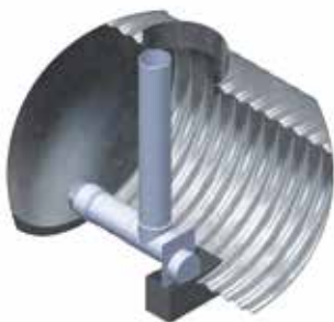
Geïntegreerde overloop Versie met uitneembare debietregelaar en verdieping
